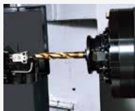
自动刀具破损检测装置 II 可选 (OMRON)
