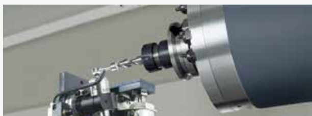
自动刀具测量装置 (TS 27R) 可选
