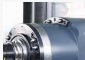
主轴顶部的冷却液喷枪
