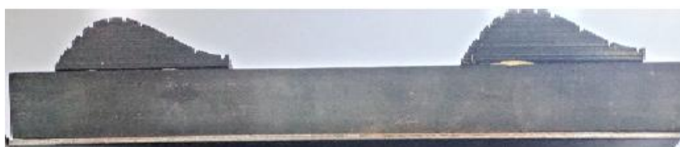
(c) 带沟槽的仿山羊蹄履带花纹单体结构实物图
