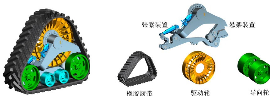
图1 拖拉机高速橡胶履带行走系统
